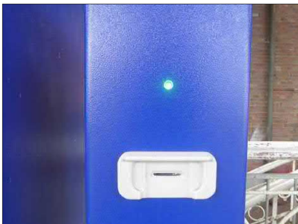
Abb. 39: Der Schlitz des einzigen Entwerfers am Bahnhof Brake war mit gefaltetem Papier verstopft.
