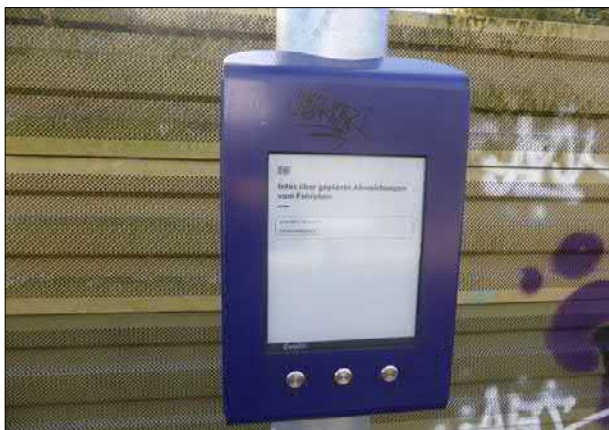
Abb. 24: Im Rahmen der Erneuerung der Dynamischer Schriftanzeiger wurden an den Stationen im Bereich der DB auch Anzeigegeräte für geplante Fahrplanänderungen wie hier an Gleis 1 in Ritterhude installiert.
